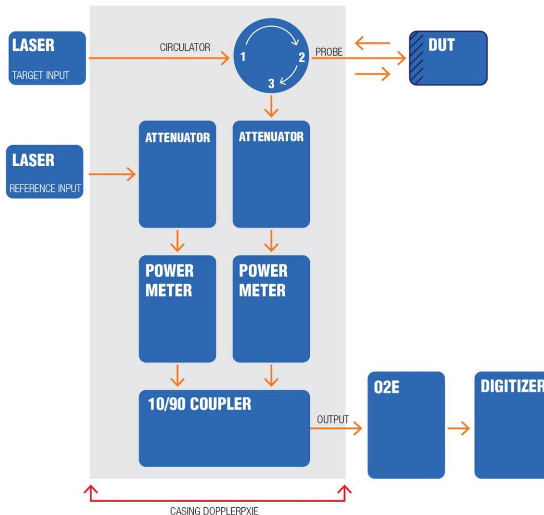
**Figure 4:** Doppler module (DopplerPXIe-1001) schematic
